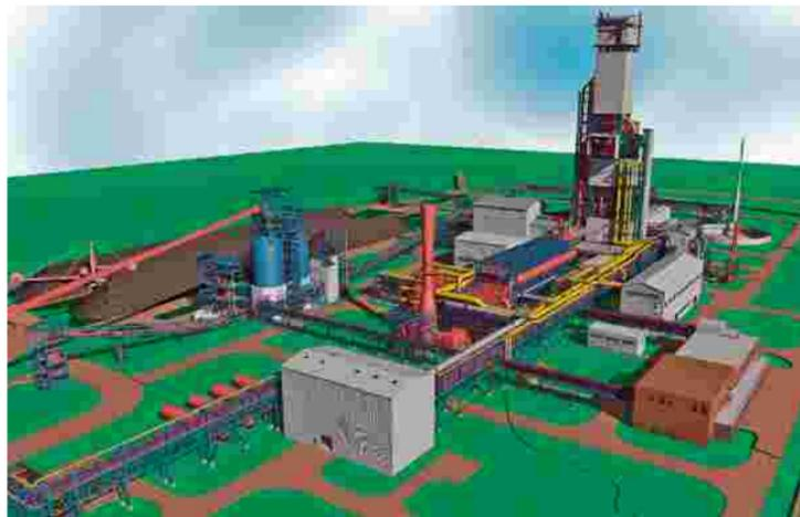
Das größte Planungsprojekt in jüngster Zeit: Medienverrohrung der Direktreduktionsanlage Lebedinsky GOK III in Russland. In dieser Anlage werden 1,8 Mio. Tonnen/Jahr metallisch reines Eisen (DRI) aus Erzen mit Hilfe von Erdgas erzeugt. Auftraggeber: Primetals Technologies GmbH, Linz.
